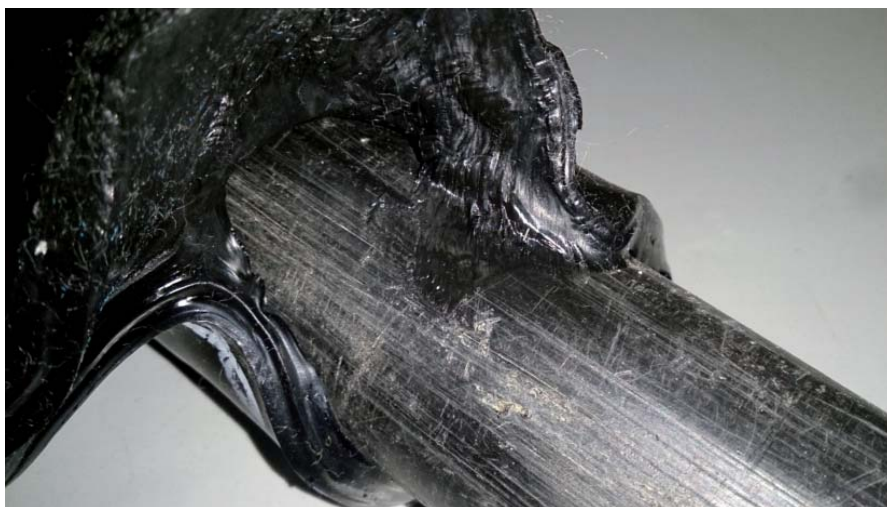
Рис. 7. Прилипание ПНД-трубы к поверхности оболочки однофазного кабеля
