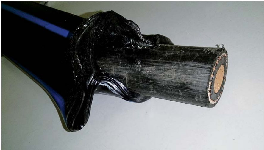
Рис. 7. Прилипание ПНД-трубы к поверхности оболочки однофазного кабеля
